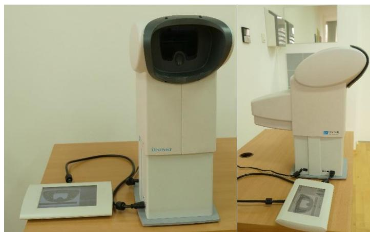
Slika 1. Prikaz ortoreter uređaja Optovist Vistec EU.
